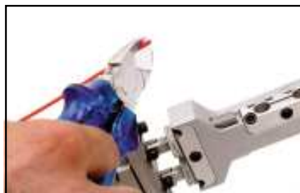
Verlängerungsröhrchen an der Spraydose schräg abschneiden.
