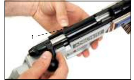
Die links (bei Linksgewehren rechts) außen an der Hülse befindliche Schlossperre (1) drücken und gleichzeitig das Schloss aus der Verschluss-hülse ziehen.
