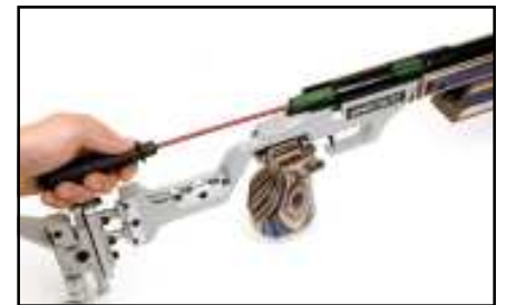
Niemals Bürste im Lauf vor- und zurückziehen. Nur in Schießrichtung putzen.
