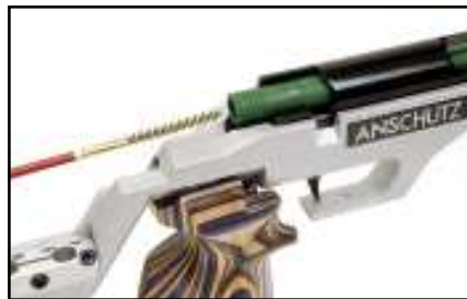
Lauf mit einer Messingbürste vom Patronenlager bis zur Mündung durchstoßen.
