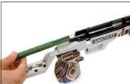
Putzstockführung 4401 (Best.-Nr. 710.6340) ein- setzen.
