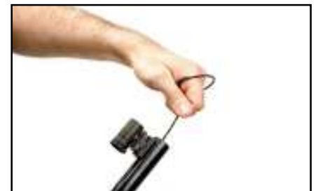
So lange wiederholen, bis der letzte Reinigungs- docht keine nennenswerten Verunreinigungen mehr aufzeigt.
