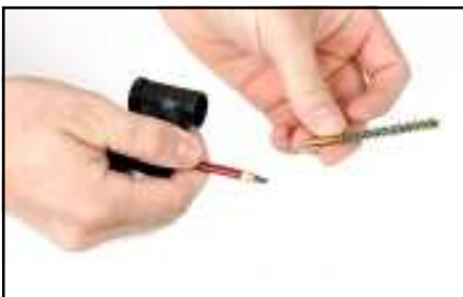
Bürste außerhalb der Mündung abschrauben und Putzstock vorsichtig durch den Lauf zurückziehen.
